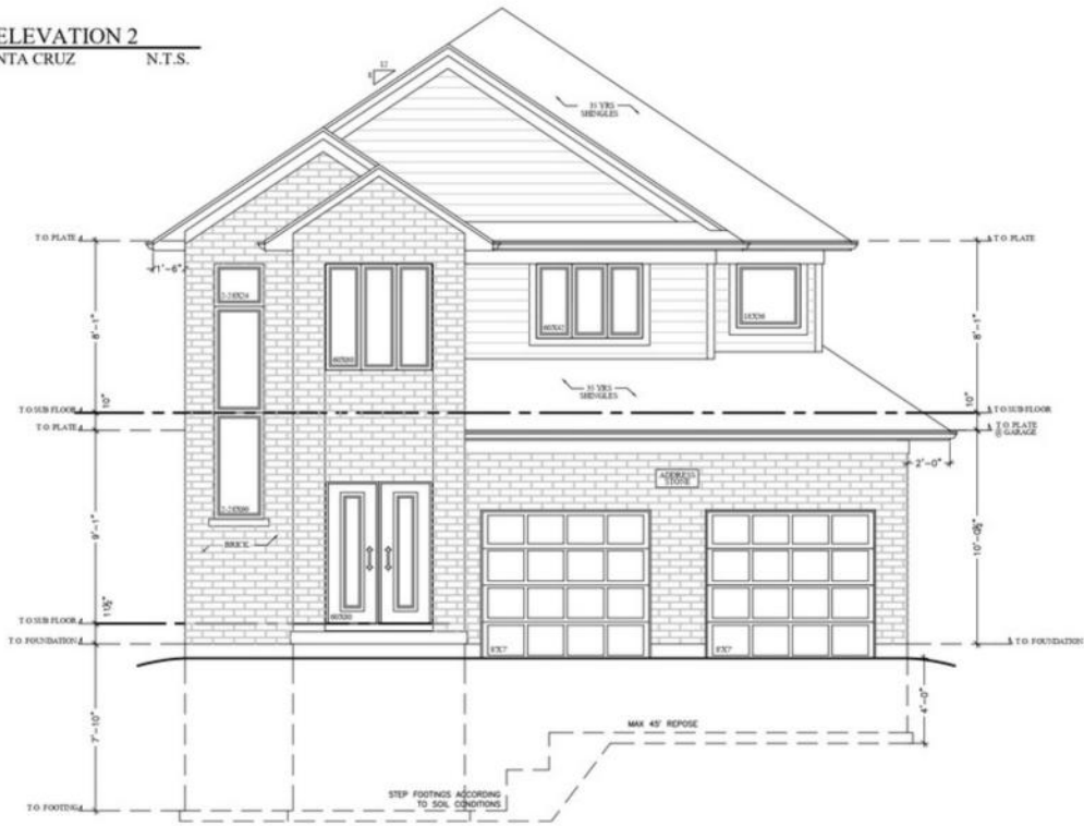
FRONT ELEVATION LUCAN-SANTA CRUZ OPTION 2 N.T.S.
